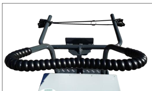
Vue arrière de la boîte de rangement, de la poignée ergonomique, du système de fixation du bac par sandow et des porte-outils caoutchouc
